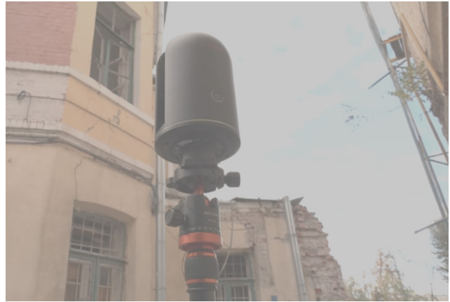
Рис. 5. Фіксація всіх пошкоджень роботом – 3-D сканером
